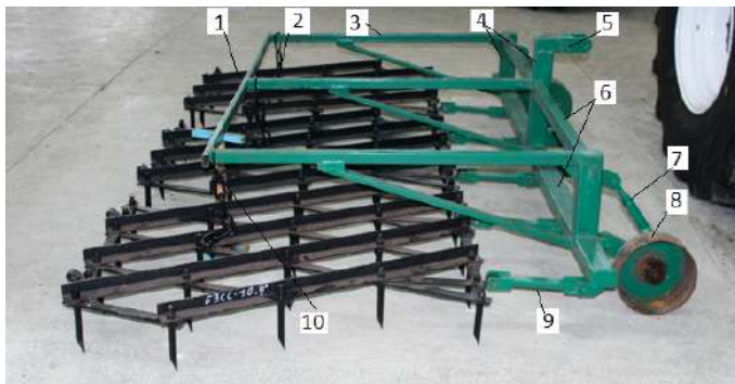
Рисунок 3 – Борновальный агрегат с шириной захвата 3,0 м (а); 6,0 м (б): 1 – борона; 2 – подвеска; 3 – продольный брус; 4 – грядиль; 5 – стойки; 6 – поперечный брус; 7 – тяги; 8 – опорное колесо; 9 – тяги; 10 – брус-ограничитель
