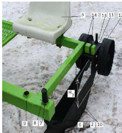
Рисунок 5 – Двухрядный посадчик черенков хмеля (а – общий вид; б – посадочное устройство): 1 – рама; 2 – сошник; 3 – сиденья; 4 – навесное устройство; 5 – платформа для ящиков; 6 – лезвия; 7 – поводок; 8,9 – отверстия; 10 – боковины; 11 – задняя опора; 12 – катки; 13 – винт; 14 – стремянки
