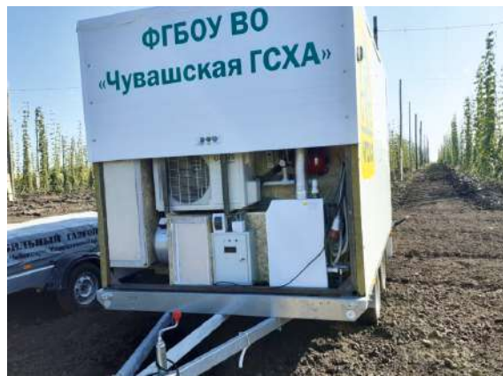
Рисунок 9 – Хмелесушилка (а – схема: 1 – мобильное шасси, 2 – транспортер промежуточный; 3 – транспортер выгрузной; 4 – модуль поворотного-стеллажного; 5 – механизм выравнивающий; 6 – транспортер загрузочный, 7 – испаритель, 8 – конденсатор-компрессор; 9 – радиатор; 10 – вентилятор; 11 – нагреватель; б – общий вид с газгольдером)
