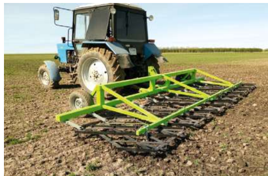
Рисунок 3 – Борновальный агрегат с шириной захвата 3,0 м (а); 6,0 м (б): 1 – борона; 2 – подвеска; 3 – продольный брус; 4 – грядиль; 5 – стойки; 6 – поперечный брус; 7 – тяги; 8 – опорное колесо; 9 – тяги; 10 – брус-ограничитель
