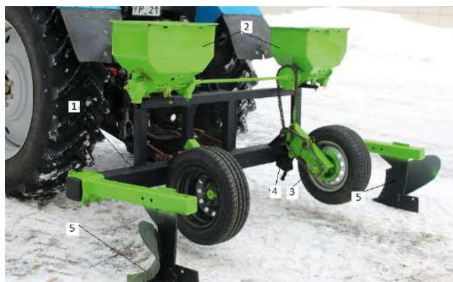
Рисунок 7 – Трансформер в режиме окучника (а – общий вид: 1 – рама; 2 – ящики; 3 – опорное колесо; 4 – регулировочный винт; 5 – корпус; 6 – грядиль; 7 – кронштейн; б – окучивание рядов хмеля с одновременным внесением удобрений)
