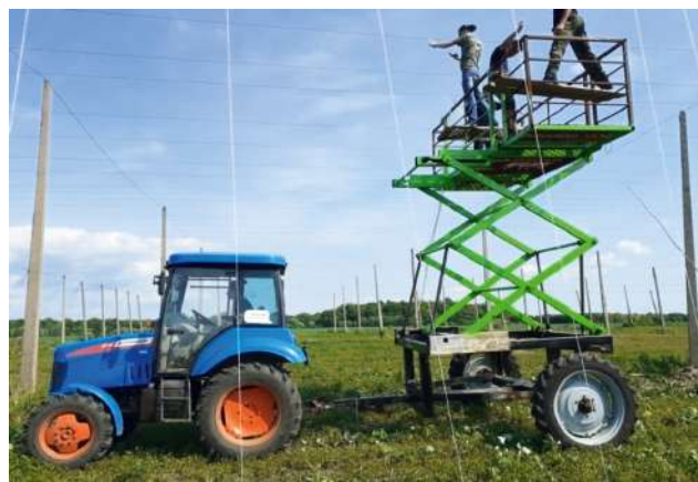
Рисунок 4 – Работа вышки по подвязке поддержек хмеля (а – схема хмелевышки; б – практическая эксплуатация): 1 – столбовой ряд; 2 – бесстолбовой ряд; 3 – колеса вышки; 4 – колеса трактора
