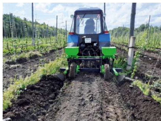
Рисунок 7 – Трансформер в режиме окучника (а – общий вид: 1 – рама; 2 – ящики; 3 – опорное колесо; 4 – регулировочный винт; 5 – корпус; 6 – грядиль; 7 – кронштейн; б – окучивание рядов хмеля с одновременным внесением удобрений)
